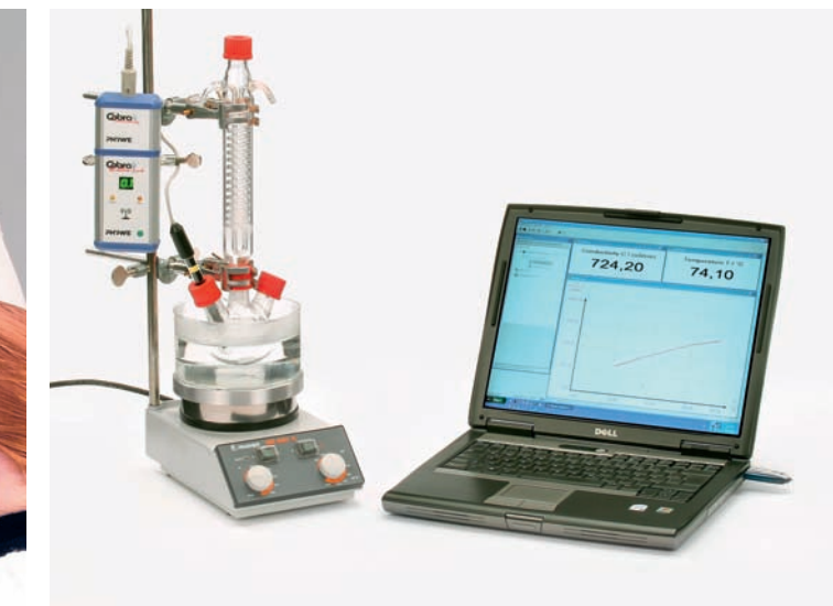
Abb: Versuch zur Temperaturabhängigkeit der Leitfähigkeit
